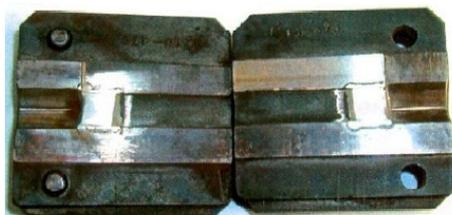
Рис. 2. Разъемная матрица для выдавливания
